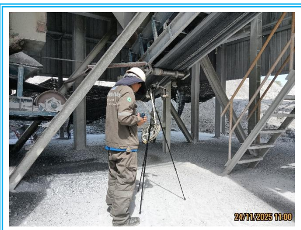
รูปที่ 4.3-12 แสดงการตรวจวัดค่าความทึบของฝุ่นละออง (Opacity) บนเครื่องย่อยที่ 2 (Secondary Crusher) วันที่ 24 พฤศจิกายน 2568
