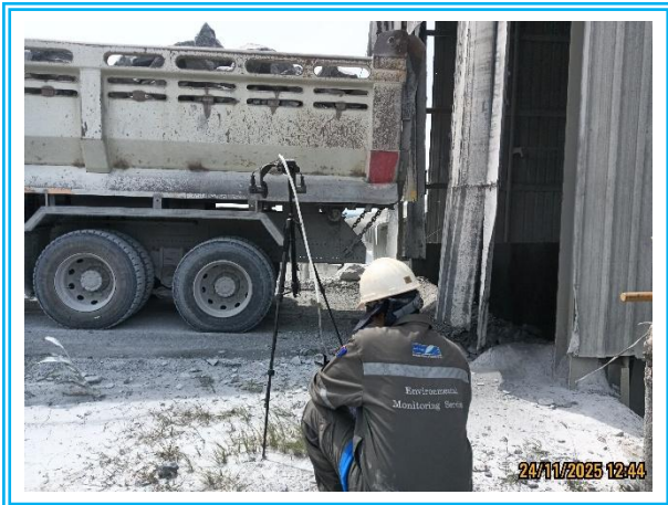
รูปที่ 4.3-10 แสดงการตรวจวัดค่าความทึบของฝุ่นละออง (Opacity) บนปากโม (Primary Crusher) วันที่ 24 พฤศจิกายน 2568
