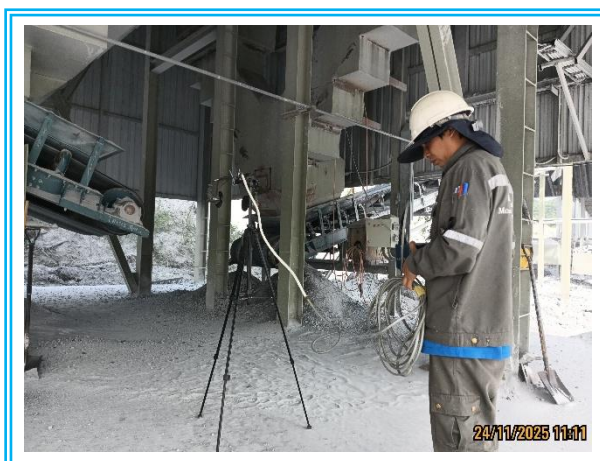
รูปที่ 4.3-13 แสดงการตรวจวัดค่าความทึบของฝุ่นละออง (Opacity) บนตะแกรงชุดที่ 1 (Screen No.1) วันที่ 24 พฤศจิกายน 2568
