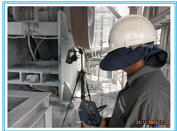
รูปที่ 4.3-11 แสดงการตรวจวัดค่าความทึบของฝุ่นละออง (Opacity) ใต้ปากโม (Primary Crusher) วันที่ 24 พฤศจิกายน 2568
