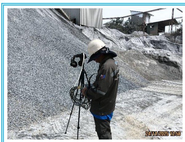
รูปที่ 4.3-14 แสดงการตรวจวัดค่าความทึบของฝุ่นละออง (Opacity) จุดถ่ายโอน (Transfer Point) วันที่ 24 พฤศจิกายน 2568
